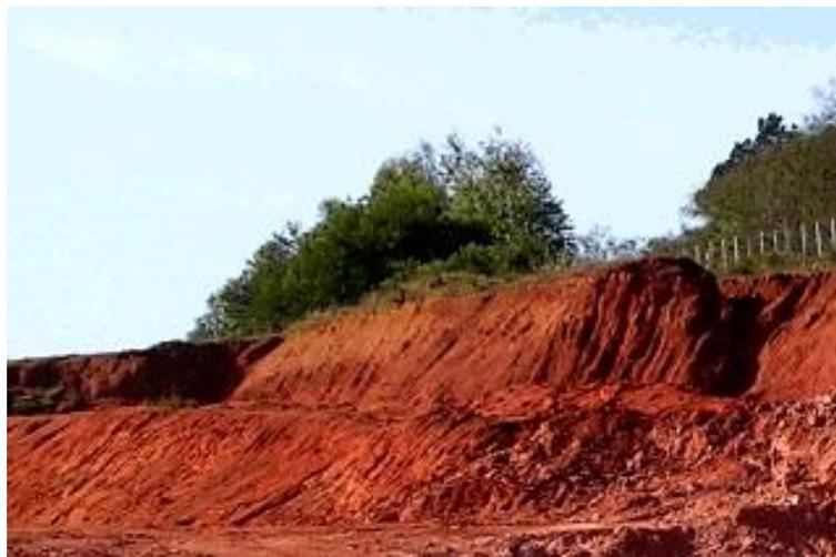
**Figura 1: Jazida de argila laterítica. Fonte: Bastos et al. (2007).**
