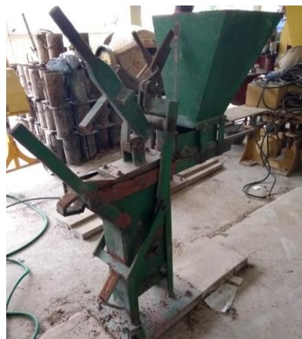
**Figura 3:** Prensa manual. Fonte: Elaborado pelos autores.
