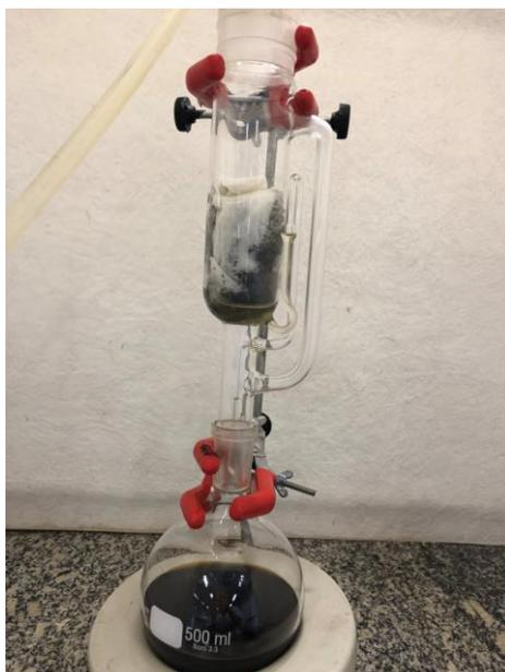
**Figura 1: método Soxhlet. Fonte: elaborada pelos autores**
