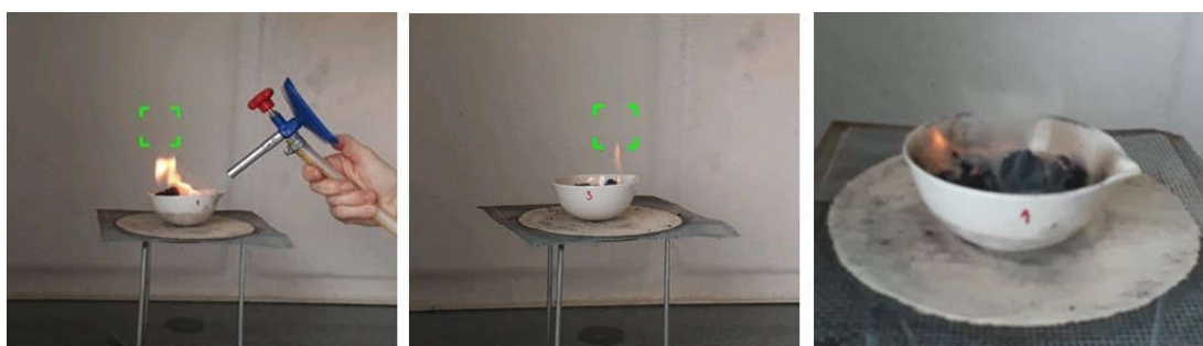
Figura 5: Queima de combustíveis sólido confeccionados com biomassa de 100 g de casca de batata inglesa e 70 g borra de café expresso. Fonte: elaborado pelos autores.
