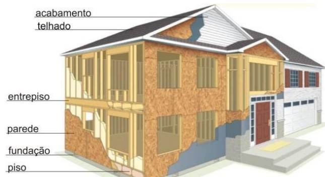
Figura 3: Perspectiva ilustrativa dos subsistemas de uma casa de Wood Frame . Fonte: APA (2012).
