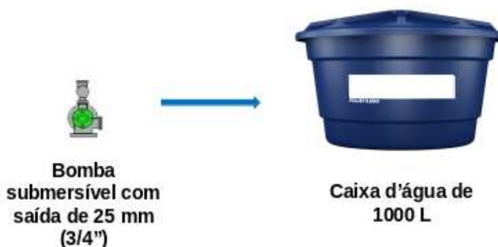
Figura 3: Sistema de captação de água antes da inclusão do filtro UV. Elaborado pelos autores.
