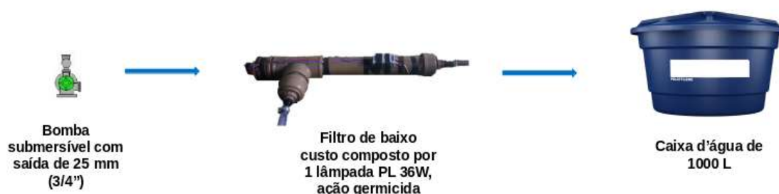
Figura 4: Fluxograma do sistema de filtração UV. Elaborado pelos autores.
