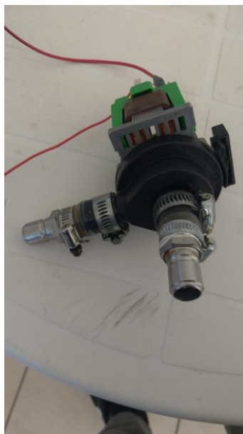
Figura 17 - Bomba de recirculação do mosto cervejeiro
