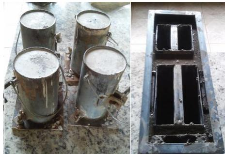
**Figura 8.** Moldagem dos corpos de prova e do bloco com forma metálica. Fonte: elaborado pelo autor
