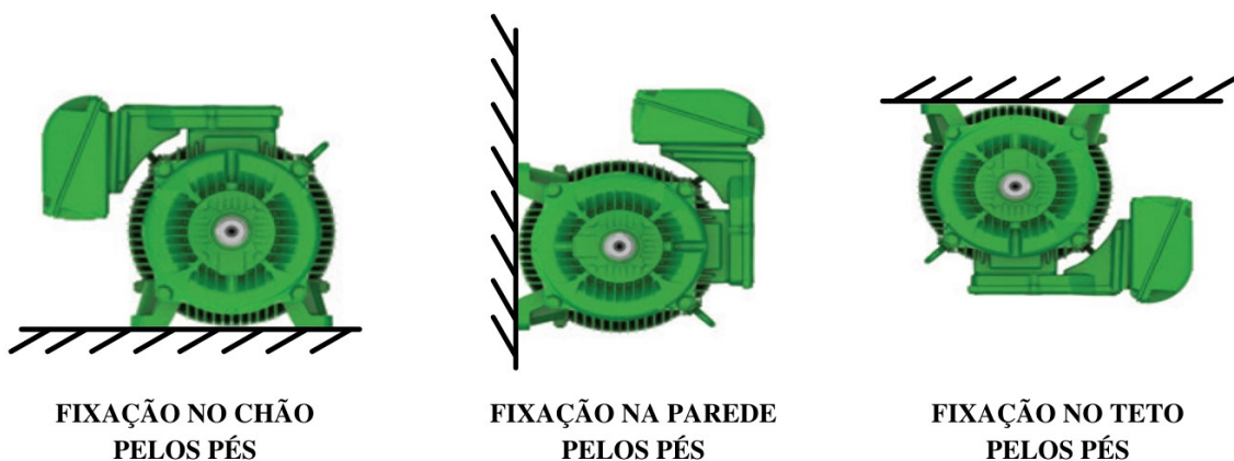
Figura 4.5 – Diferentes formas de fixação de um motor elétrico
