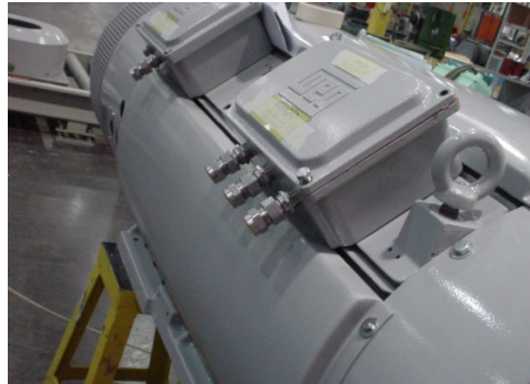
Figura 5.7 – Motor com caixa de ligação com 3 furos na caixa de ligação
