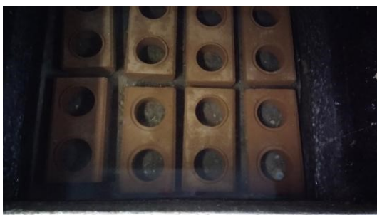
Figura 5- Ensaio de absorção de água. Fonte: elaborado pelos autores.
