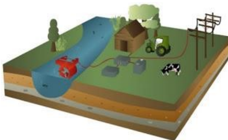
Figura 10: Esquema de localização da balsa (flutuante) com a margem do rio. Fonte: ECOIST.
