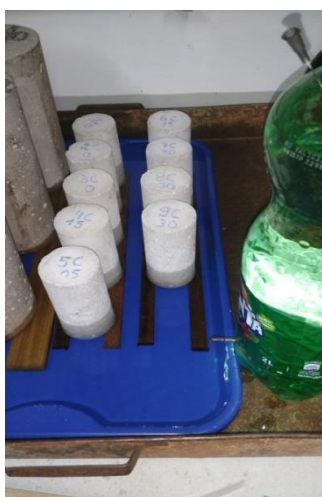
Figura 10: Ensaio de absorção após 3 horas. Fonte: Elaborado pelos autores.
