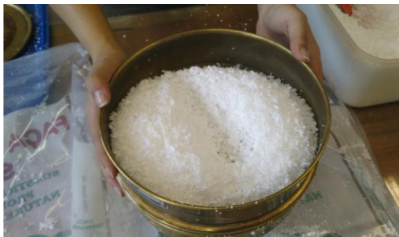
Figura 2: Poliestireno expandido sendo peneirado. Fonte: Elaborado pelos autores.
