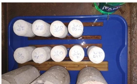
Figura 5: Suporte para o ensaio de absorção por capilaridade. Fonte: Elaborado pelos autores.
