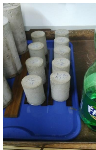
Figura 11: Ensaio de absorção após 72 horas. Fonte: Elaborado pelos autores.
