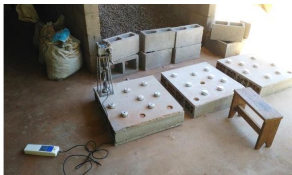
Figura 4: Execução do ensaio de arrancamento. Fonte: Elaborado pelos autores.
