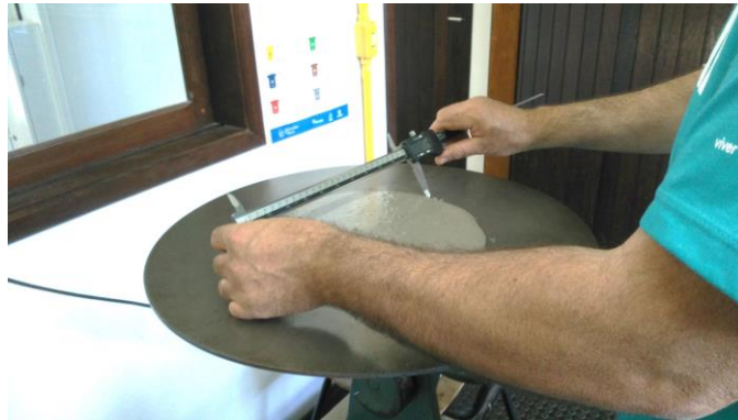
Figura 5: Medidas do espalhamento da argamassa. Fonte: Elaborado pelos autores.
