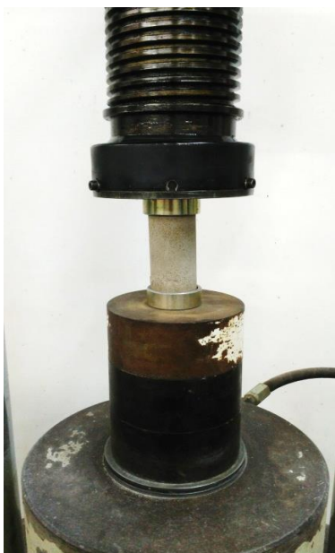
Figura 7: Ensaio de resistência à compressão. Fonte: Elaborado pelos autores.
