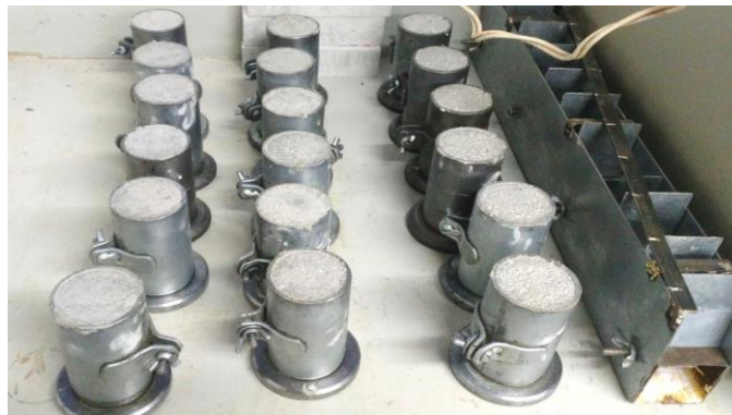
Figura 6: Corpos de prova após a moldagem. Fonte: Elaborado pelos autores.
