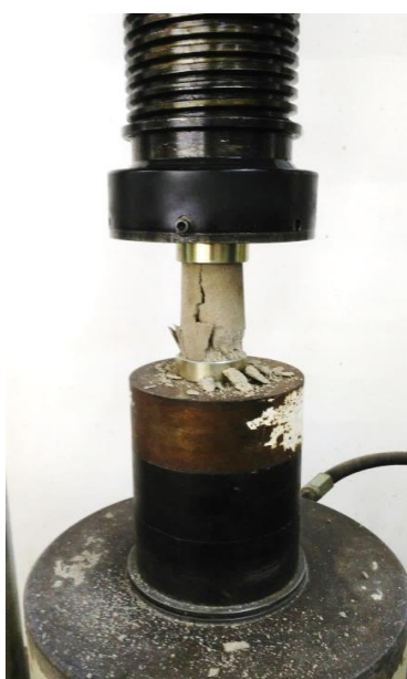
Figura 9: Ruptura à compressão. Fonte: Elaborado pelos autores.
