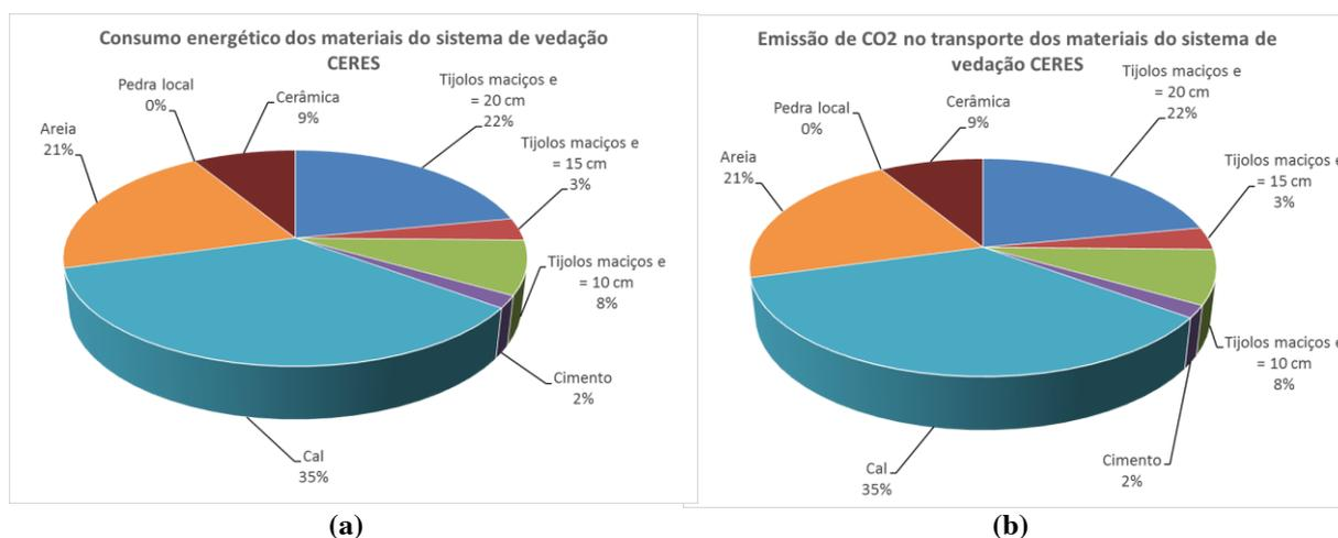
**Figura 4: (a) Consumo energético associado a transporte do subsistema de vedação e revestimentos do CERES, e (b) Emissão de CO<sub>2</sub> no transporte dos materiais do subsistema de vedação CERES**
