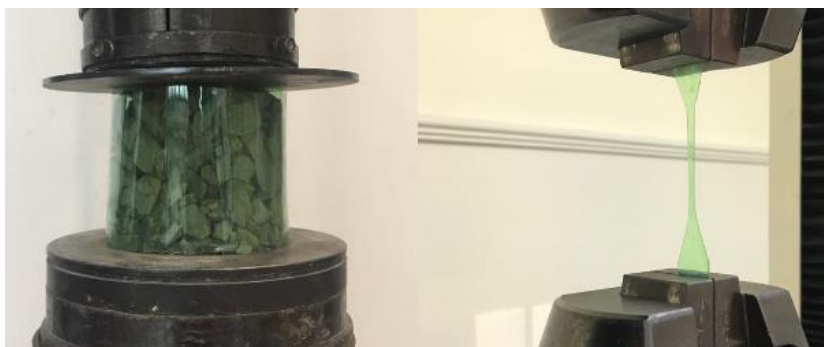
Figura 4: Ensaios de compressão e tração. Fonte: elaborado pelos autores.
