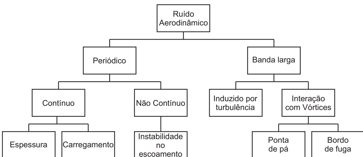
Figura 11 – Fontes de ruído aerodinâmico de uma hélice
