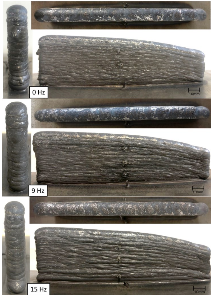
Figura 77. Imagens das paredes soldadas com frequência de alimentação de 0 Hz, 9 Hz e 15 Hz, apresentando a vista frontal, superior e lateral.
