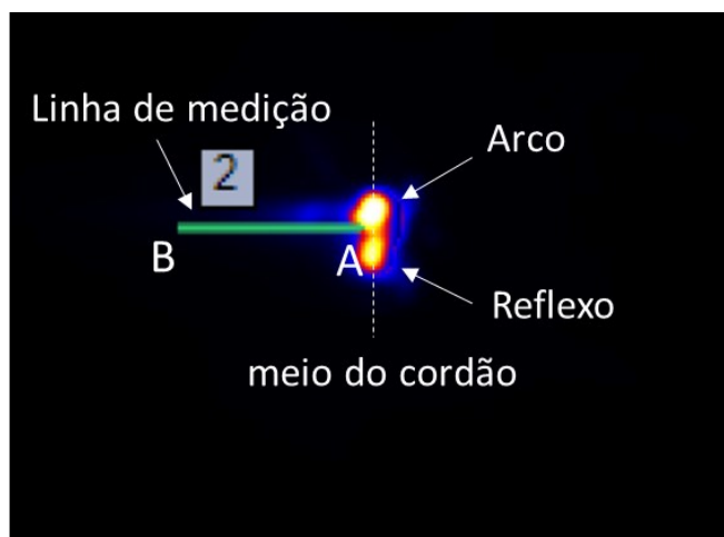
Figura 40. Metodologia de análise de temperatura dos cordões através dos vídeos obtidos pela filmagem térmica.
