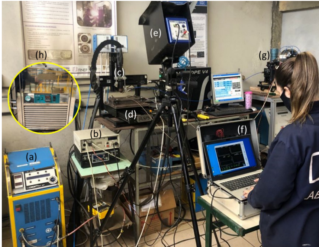
Figura 13. Bancada de ensaios: (a) Fonte de energia, (b) controlador do módulo de alimentação dinâmica, (c) tocha plasma, (d) manipulador robótico, (e) câmera térmica, (f) sistema de aquisição portátil (SAP), (g) módulo de alimentação dinâmica (MAD).
