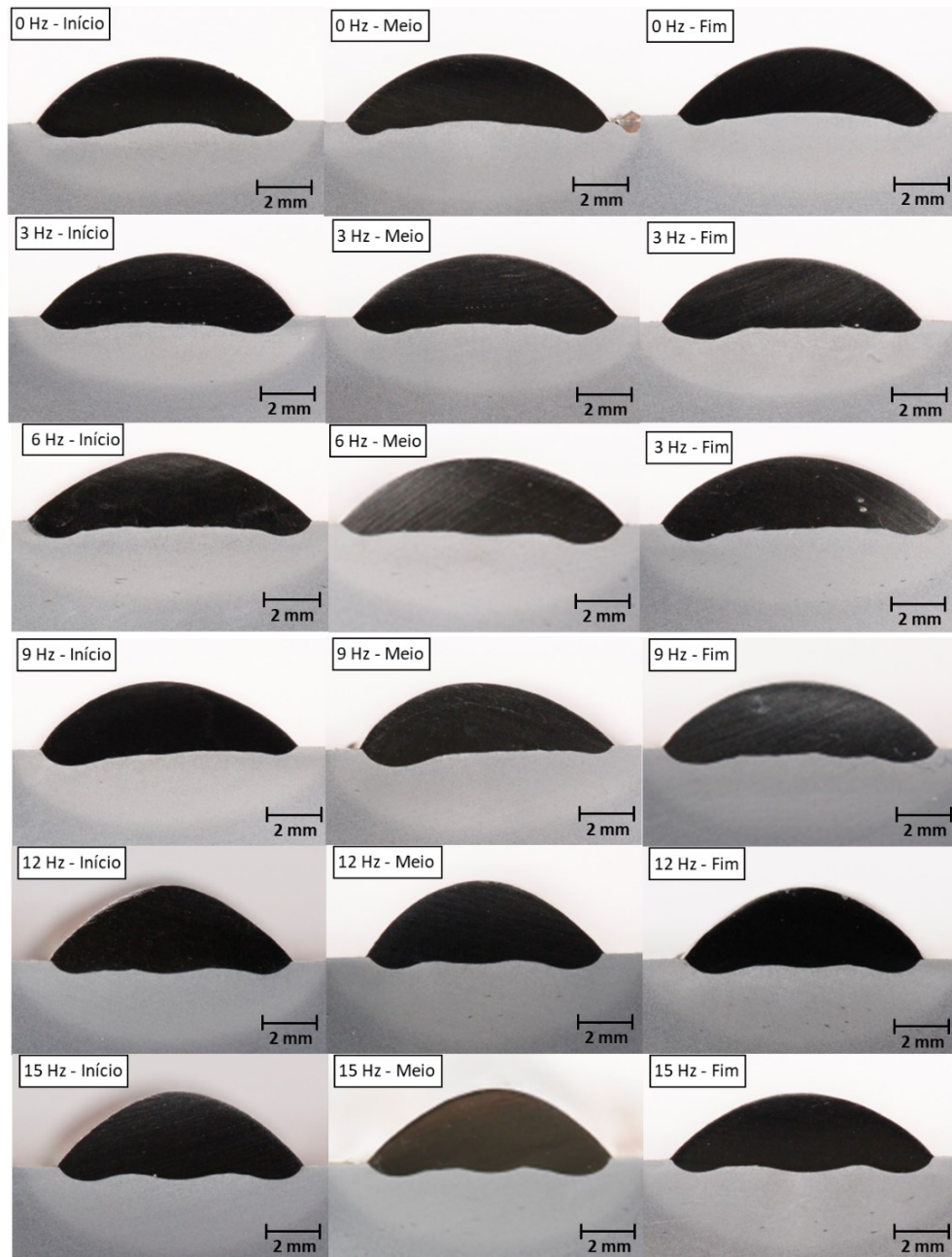
Figura 70. Resultados do corte transversal dos cordões para as diferentes frequências de alimentação de arame.
