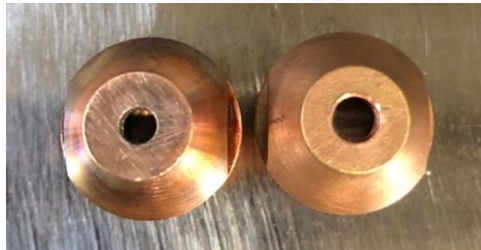
Figura 27. Bico constritor da tocha plasma PWM 300 com diâmetro de 3,2 mm e diâmetro de 3,9 mm.
