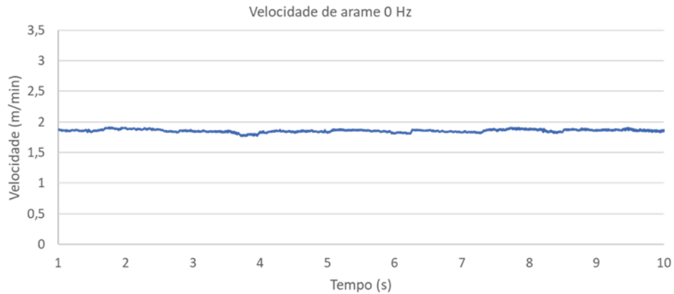
Figura 50. Gráfico da velocidade x tempo da soldagem com alimentação contínua de arame.
