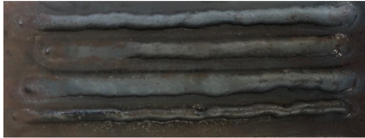
Figura 19. Aspecto irregular dos cordões depositados nos ensaios iniciais com o processo plasma alimentado.
