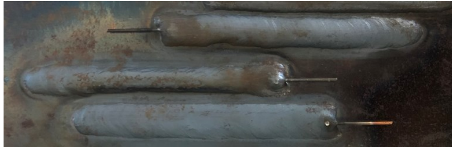
Figura 21. Cordões depositados nos ensaios iniciais evidenciando o arame solidificado junto com a poça ao final do processo.
