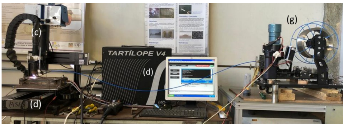
Figura 14. Bancada de ensaios: (c) Tocha plasma, (d) controlador do manipulador robótico e manipulador robótico, (g) módulo de alimentação dinâmica (MAD).
