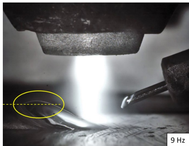
Figura 63. Momento em que uma porção de metal líquido está no topo da poça a uma altura maior que o cordão já solidificado. Soldagem com frequência de 9 Hz. Vídeo
