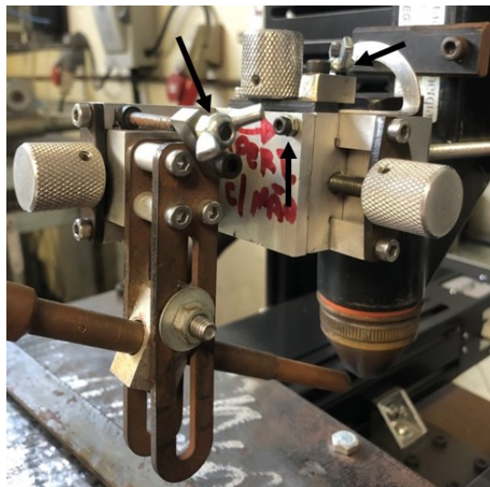
Figura 20. Direcionador de arame utilizado nos ensaios iniciais com o processo plasma após a implementação das travas nos eixos de movimentação.
