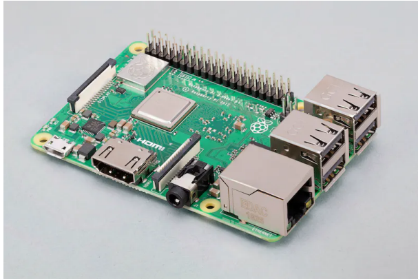
Figura 15 – Raspberry Pi 3B+ Fonte: Retirado de [35]
