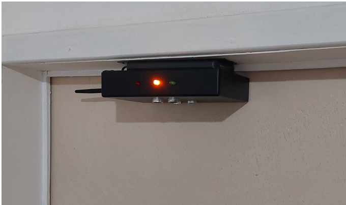
Figura 26 – Unidade contadora em modo stand-by
