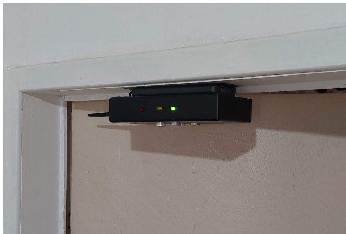
Figura 27 – Unidade contadora em modo monitoramento
