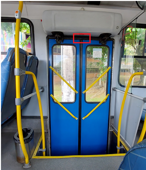
Figura 19 – Local de fixação proposto para a unidade contadora Fonte: O autor
