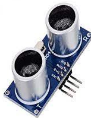
Figura 17 – Sensor de obstáculos com tecnologia ultrassônica HC-SR04
