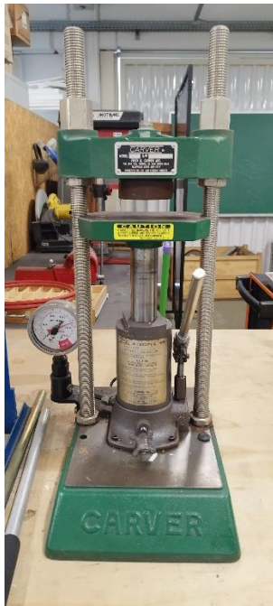
Figura 18 - Prensa hidráulica utilizada para resfriamento dos corpos de prova
