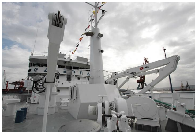
Figura 15 – Guindaste para trabalhos gerais de convés.
