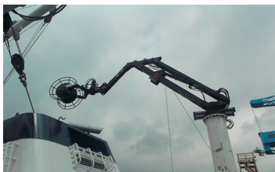
Figura 18 – Guincho estivador a bordo de embarcação atuneira de cerco.
