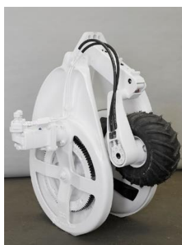
Figura 13 – Equipamento power block .
