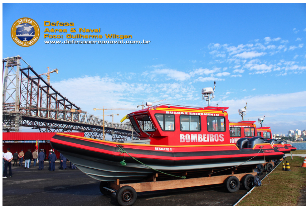
Figura 10 – Embarcação RBB em Polietileno de Alta Densidade.
