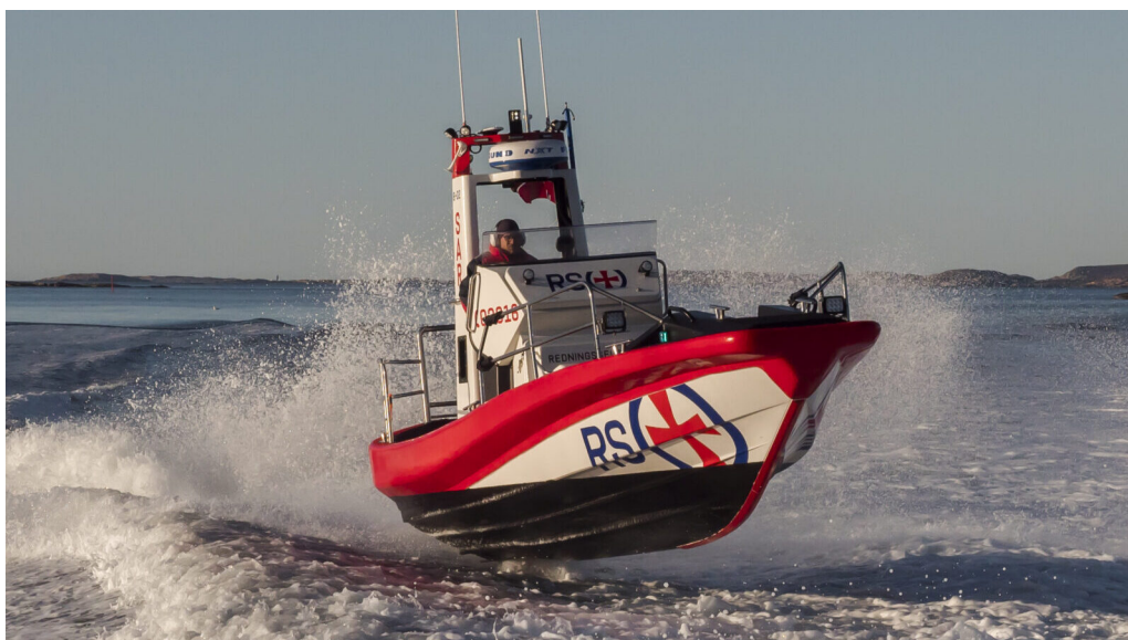
Figura 9 – Embarcação com casco rígido em fibra de vidro.
