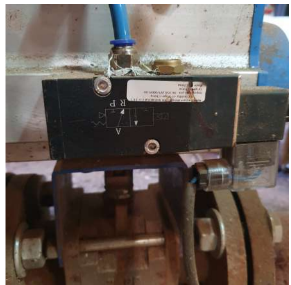
Figura 34 – Diagrama Pneumático do Solenoide Acoplado a Válvula
