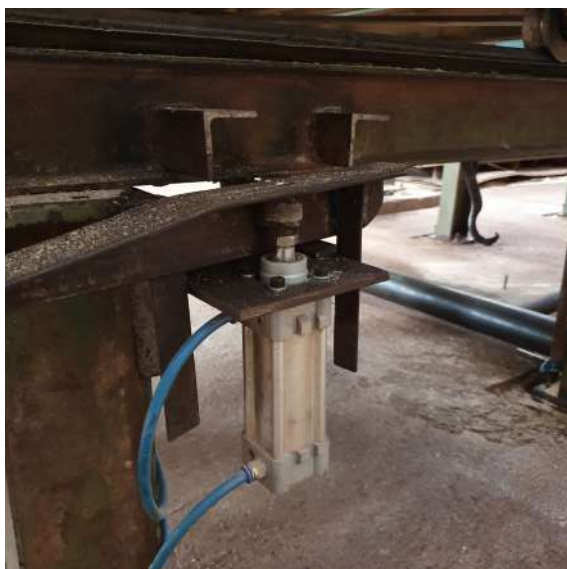
Figura 7 – Pistão pneumático utilizado em uma esquadrejadeira
