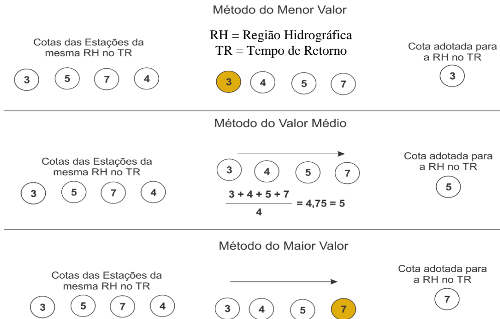
Figura 4 – Métodos de escolha da cota de inundação.
