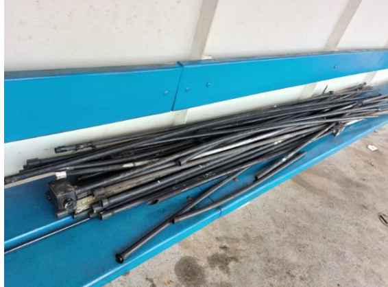
Figura 18 – Dutos de passagem de cabos elétricos removidos de uma embarcação em reforma.
