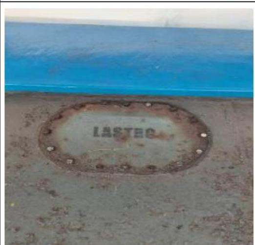
Foto 15 - Elipse para tanque de lastro.
