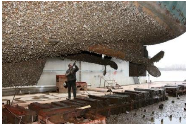
Figura 21 – Cracas formadas no casco da embarcação.
