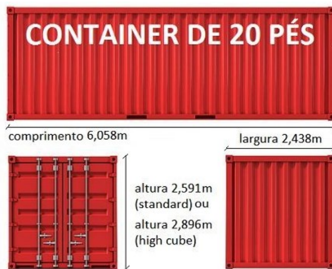
Figura 8 – Contêiner do tipo Dry Box 20 pés (medidas do Standart e High Cube).
