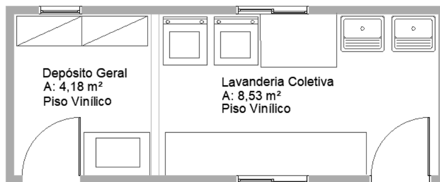
Figura 14 – Módulo Lavanderia Coletiva/Depósito Geral.
