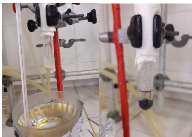
Figura 17. Reação de redução do Pd/PEClm com o ácido ascórbico. Antes (esquerda) e após (direita) aquecimento.
