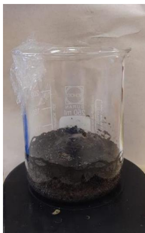
Figura 13. Reação de redução do Pd/PECIm com o NaBH 4 .
