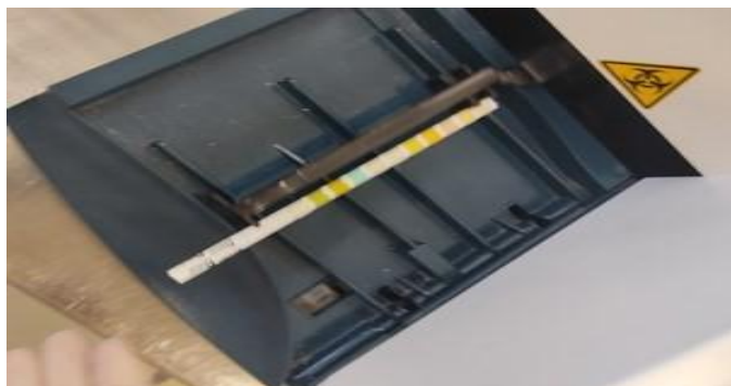
Figura 4 - tira reativa corretamente posicionada no aparelho Dirui H-500
