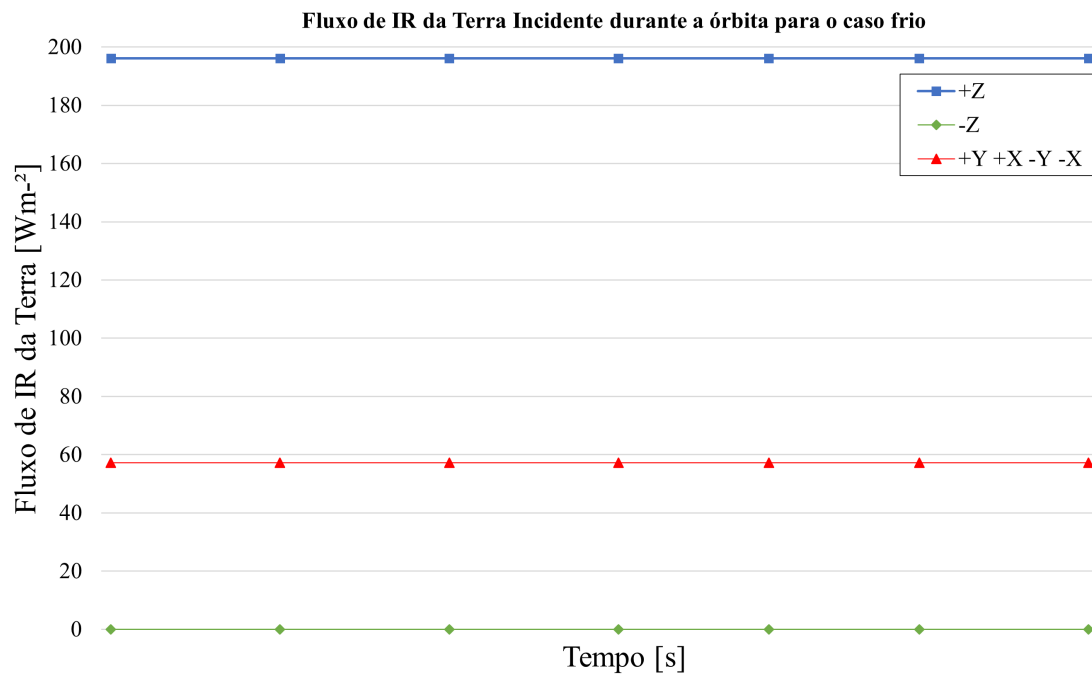
Figura 34 – Fluxo de IR terrestre incidente nas faces do satélite para o caso frio.
