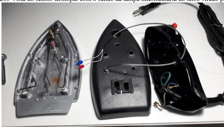
Figura 203 Vista do sensor termopar com o fundo da tampa intermediária do ferro virado para baixo
