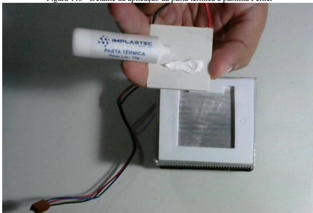
Figura 113 - Detalhe da aplicação da pasta térmica à pastilha Peltier
