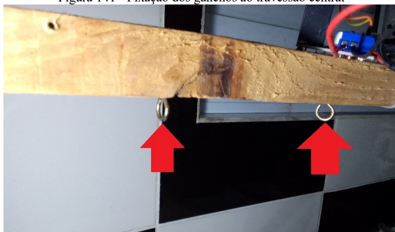
Figura 141 - Fixação dos ganchos ao travessão central
