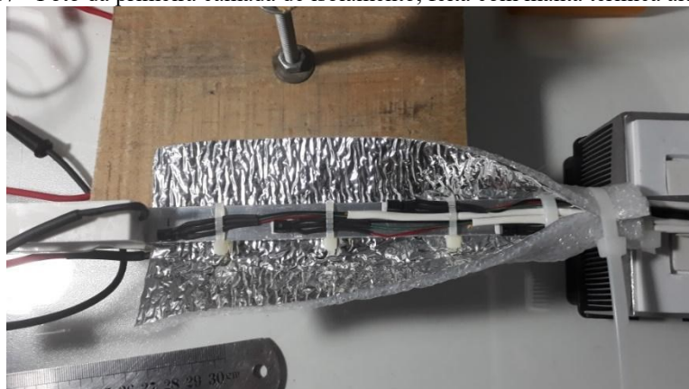
Figura 117 - Foto da primeira camada de isolamento, feita com manta térmica aluminizada.
