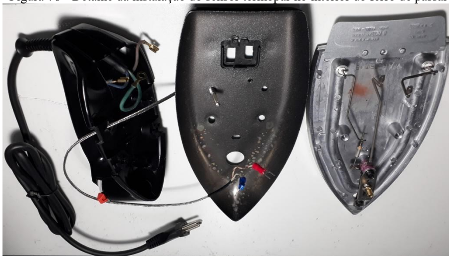
Figura 76 - Detalhe da instalação do sensor termopar no interior do ferro de passar
