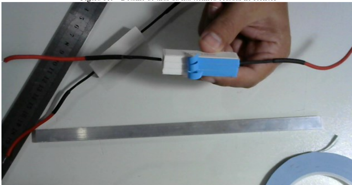
Figura 109 - Detalhe de tiras da fita térmica coladas no resistor
