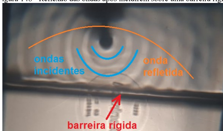
Figura 148 - Reflexão das ondas após incidirem sobre uma barreira rígida
