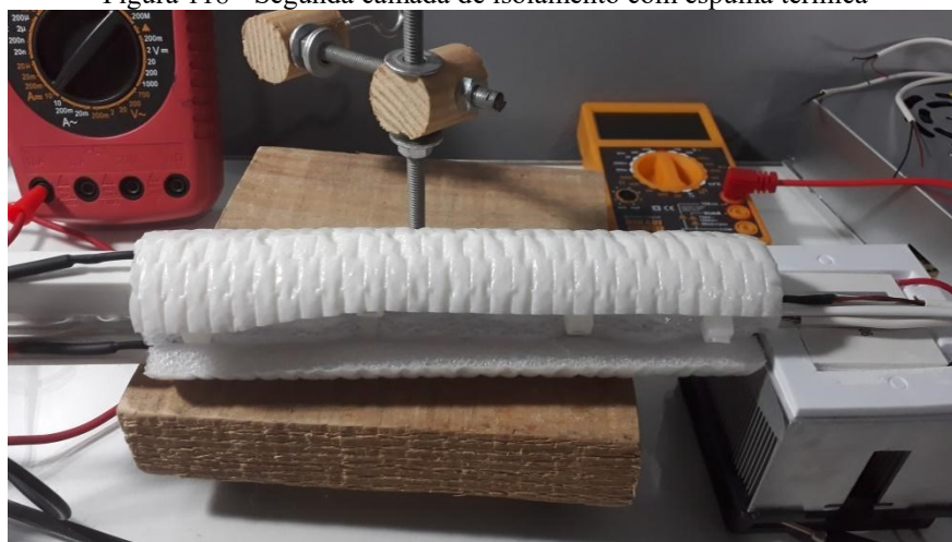
Figura 118 - Segunda camada de isolamento com espuma térmica
