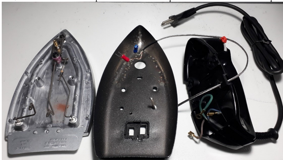
Figura 204 - Vista do sensor termopar com o fundo da tampa intermediária do ferro virado para cima
