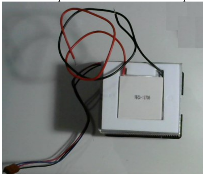
Figura 114 - Detalhe da pastilha Peltier instalada sobre o dissipador de calor
