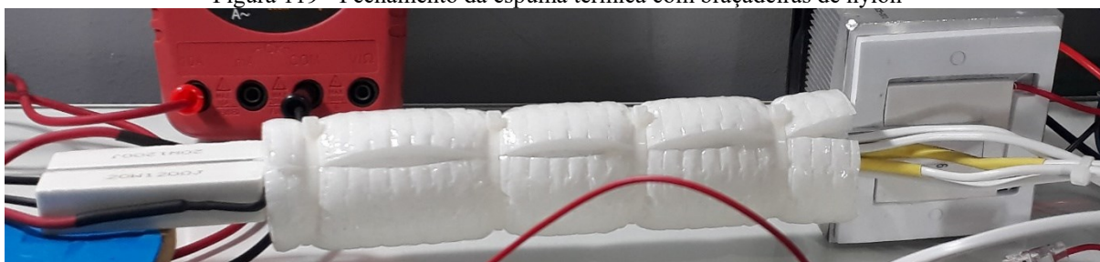
Figura 119 - Fechamento da espuma térmica com braçadeiras de nylon
