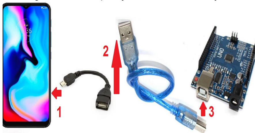
Figura 101 - Comunicação da placa de Arduino com o smartphone
