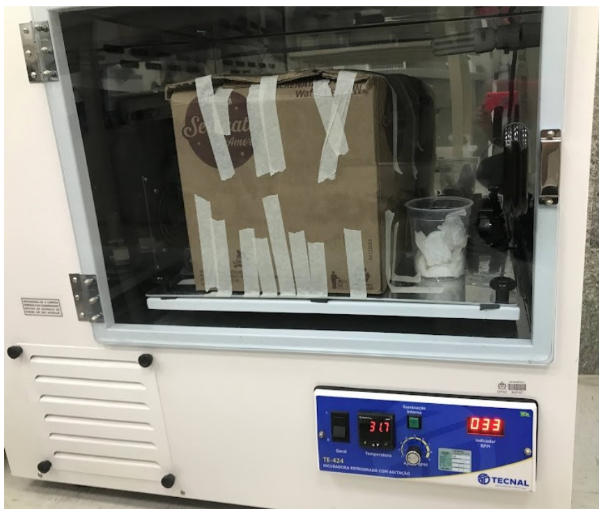
Figura 14 – Simulação de um tanque de água de lastro utilizando uma incubadora orbital com controle de temperatura ( shaker ).
