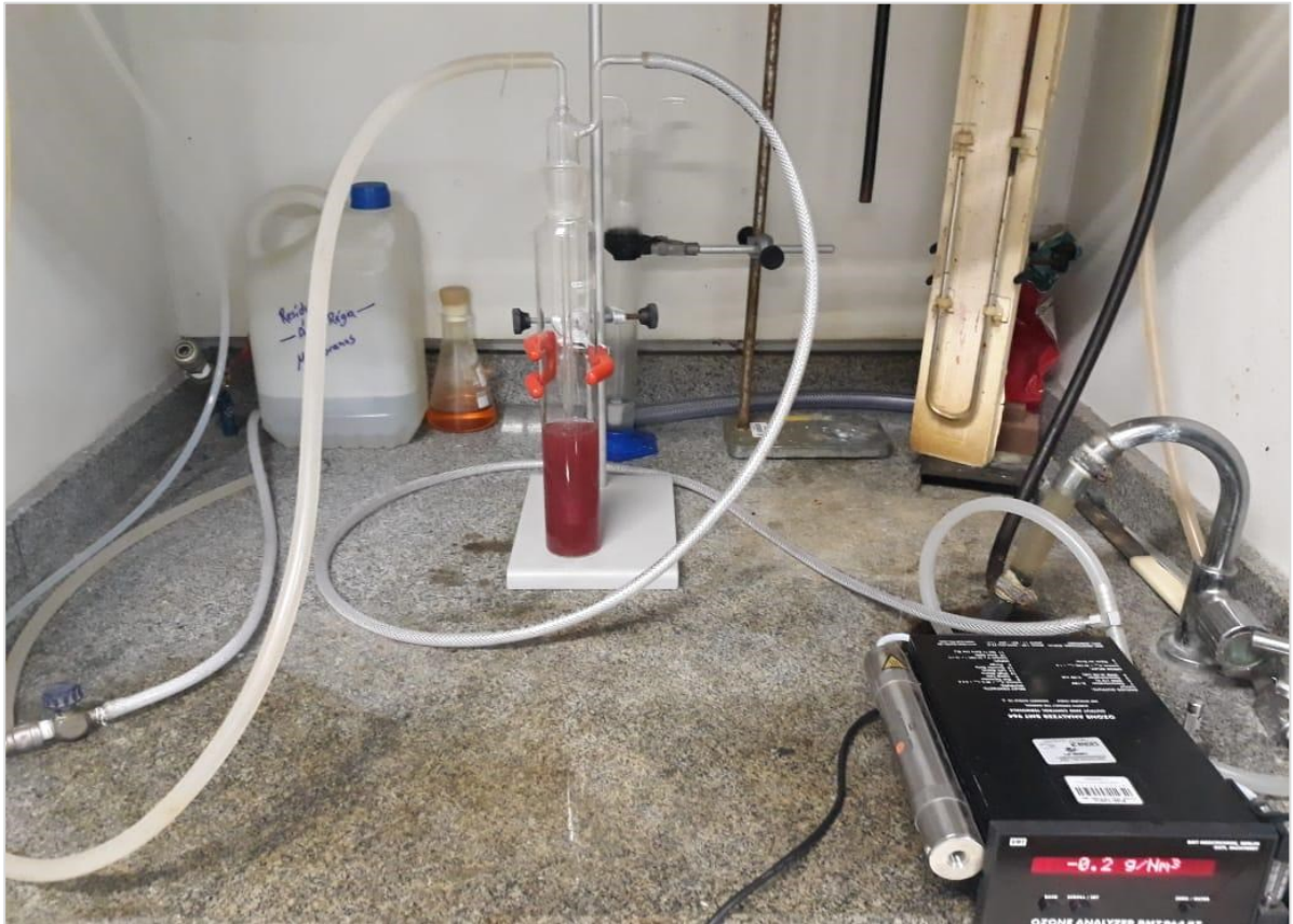
Figura 19: Sistema de oxidação com bolhas de O 3 .
