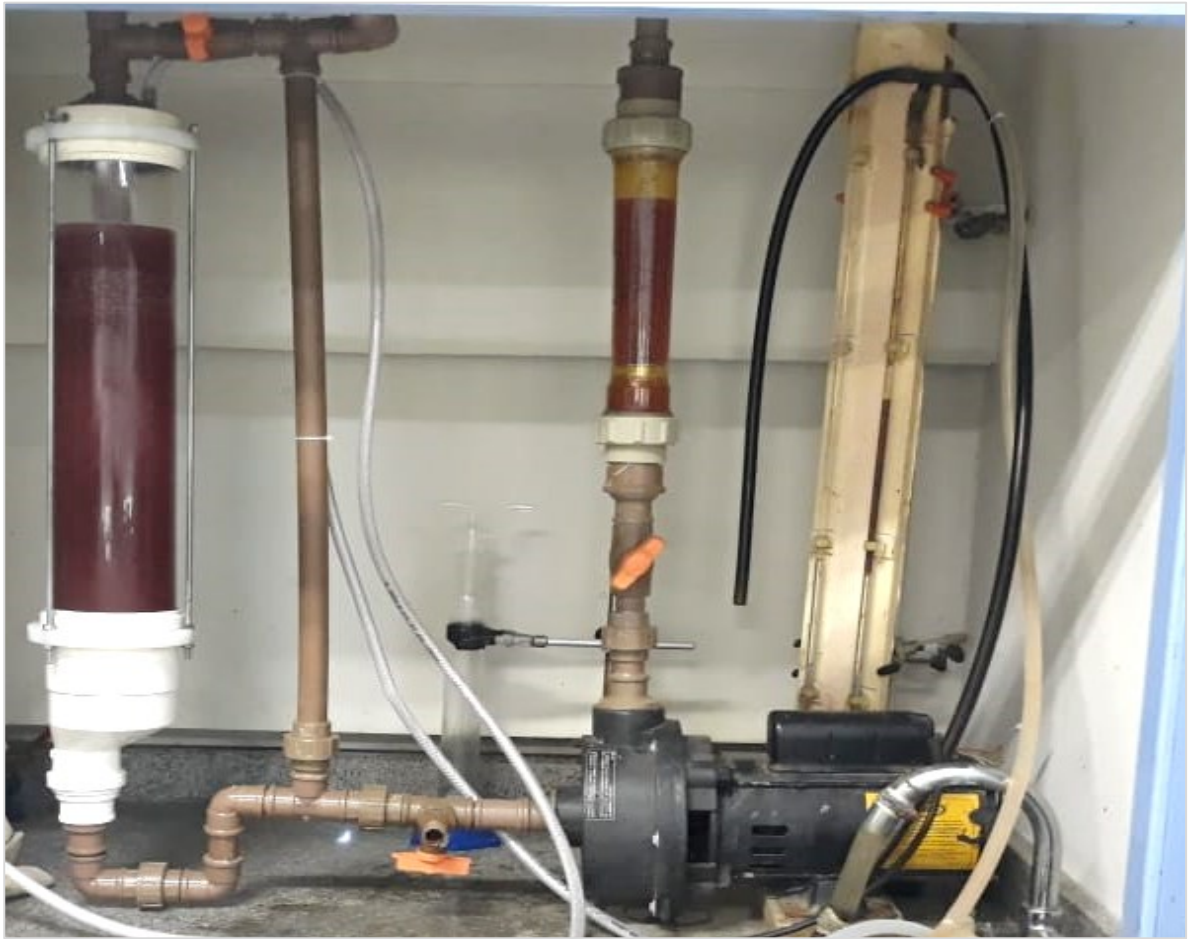
Figura 21: Segundo reator R-HC 2 construído e com solução.
