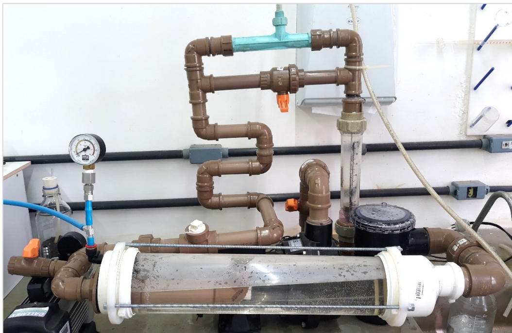
Figura 12: Sistema de cavitação hidrodinâmica utilizado R-HC 3 .
