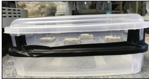
Figura 9 – Recipiente com dois níveis: inferior: solução saturada; superior: amostra.
