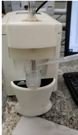
Figura 14 - Equipamento usado para a titulação simulando a primeira etapa da síntese dos nanomateriais.
