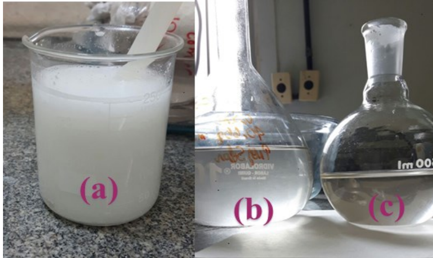
Figura 5 - a) Mistura do P-sub com água, mostrando insolubilidade; b) solução de P-sub obtida com adição de HCl 6 mol/L (25 ml/L da solução); c) solução após filtragem.
