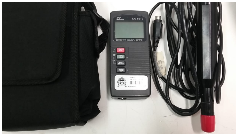
Figura 13 - Sonda amperométrica utilizada na determinação de OD.
