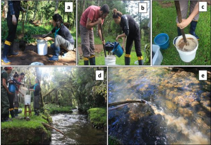
Figura 8. 1. Metodologia utilizada para a adição de sedimento fino no riacho (a) o sedimento foi coletado e peneirado; (b e c) o sedimento foi diluído num balde de 20 litros; (d) o sedimento diluído foi colocado num recipiente conectado a uma mangueira fixada no ponto do riacho selecionado para a amostragem. (e) detalhe do sedimento fino sendo liberado no riacho.
