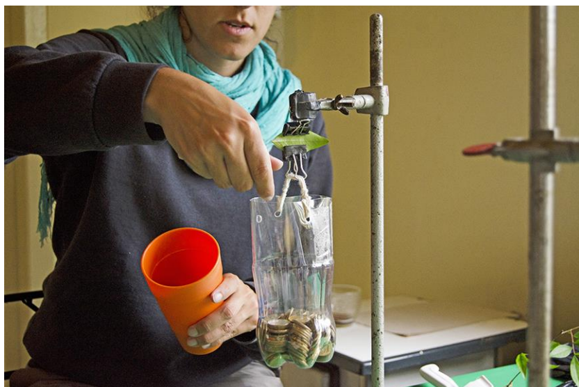
Figura 2.1. Rupturômetro usado para a medida da resistência e abscisão foliar.
