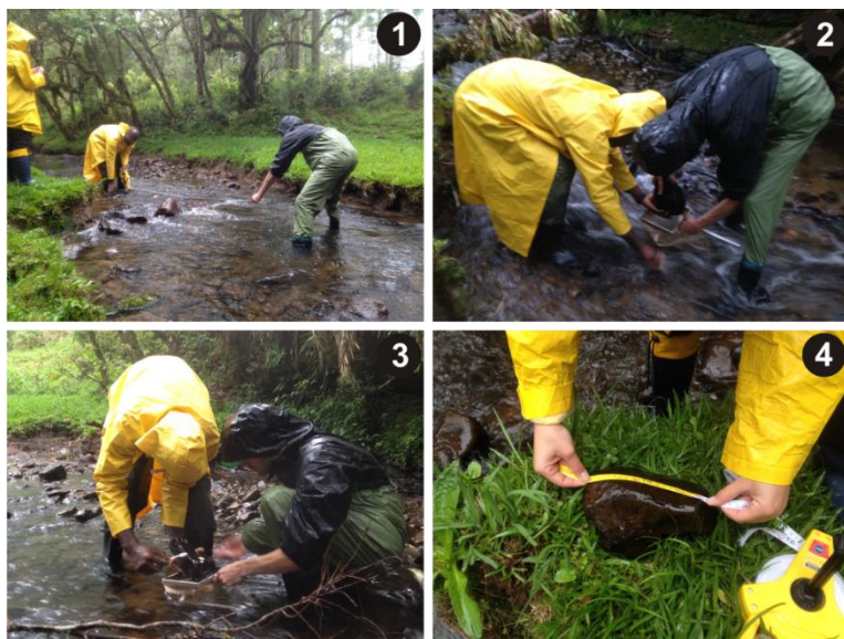
Figura 9. 2. Esquema de amostragem de dados. 1 – Velocidade da corrente; 2 - Lavagem dos seixos; 3 – Raspagem dos seixos; 4 – Comprimento dos seixos.
