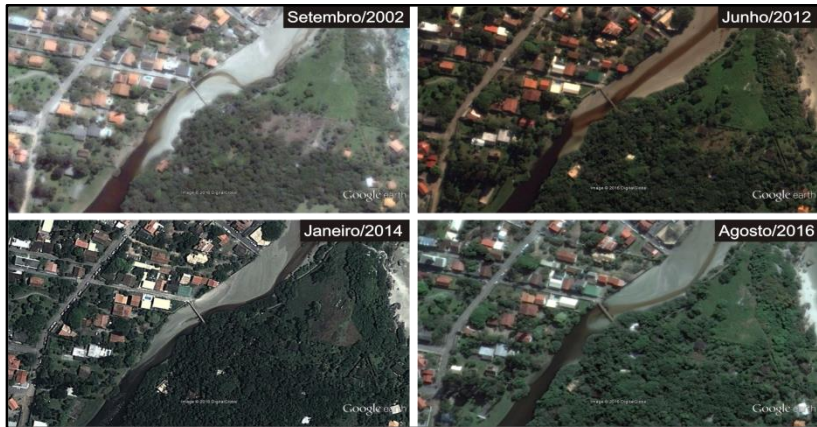
Figura 21. 4. Série histórica de imagens aéreas da área estudada. Nota-se as distintas configurações do canal sangradouro ao longo do tempo, associadas a variações no aporte fluvial e marinho.
