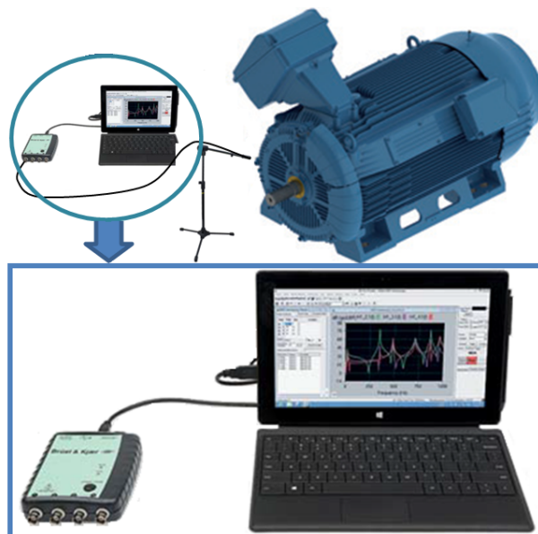
Figura 26 – Esquema da cadeia de medição para pressão sonora.
