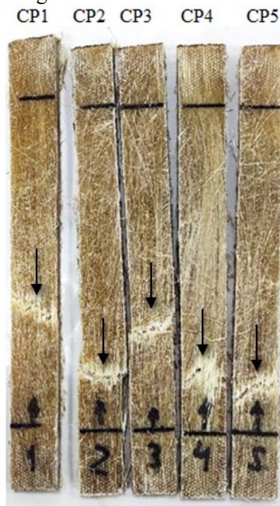
Figura 31 – Região das fraturas dos CPs da Amostra 1.
