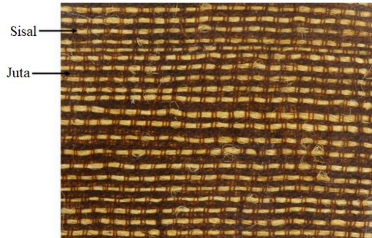
Figura 16 – Tecido de juta contendo fibras de sisal costuradas e alinhadas.
