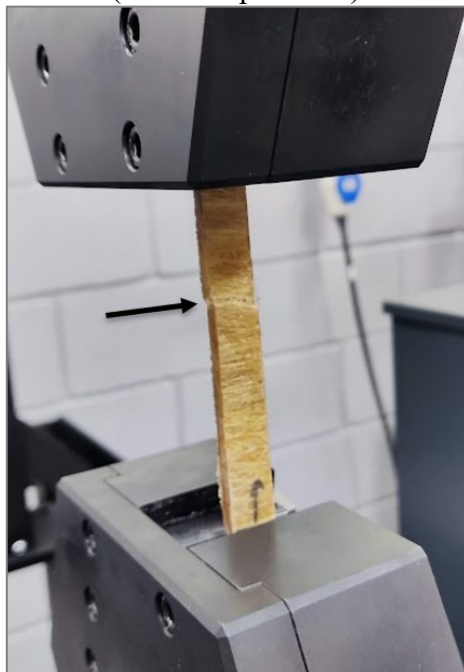
Figura 30 – Corpo de prova fraturado na região central entre as garras da máquina de ensaios (indicado pela seta).
