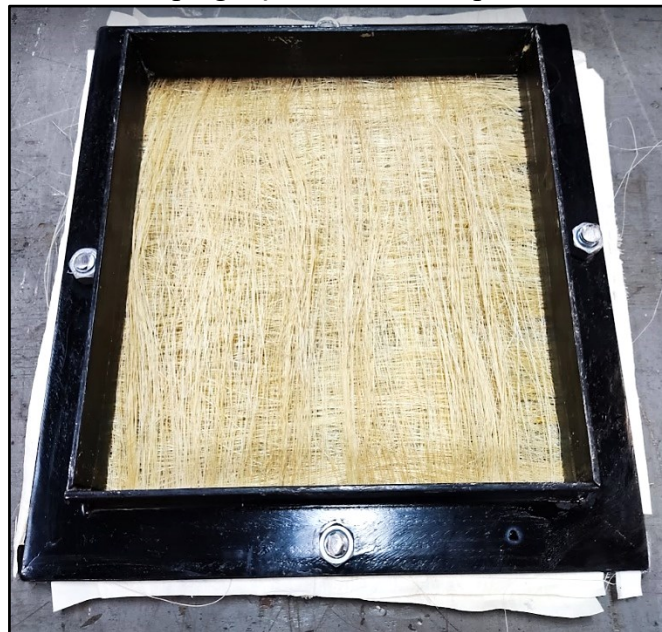
Figura 26 – Feixes contendo as fibras de sisal organizadas sobre o molde antes da impregnação com resina epóxi.
