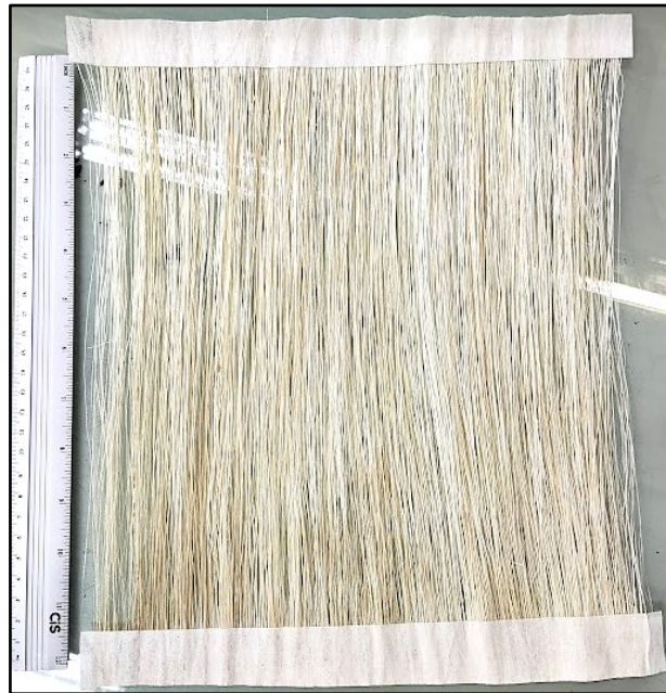
Figura 25 – Organização das fibras de sisal para composição das camadas.
