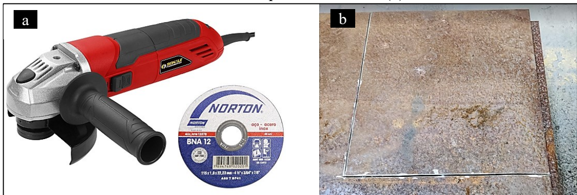
Figura 21 – Esmerilhadeira angular e o disco utilizado para o corte da placa base (a) e a placa base durante o processo de corte (b).
