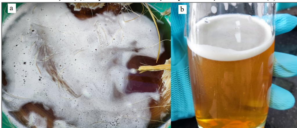
Figura 19 – Fibras de sisal imersas em solução de NaOH 5% durante o tratamento de mercerização (a), e aparência da solução após remoção das fibras (b).
