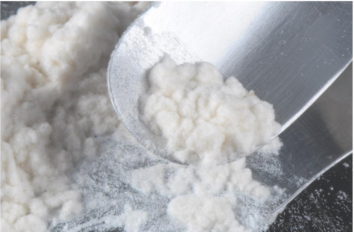
Figura 4: Fibras naturais de sílica amorfa, previamente à mistura com PEEK;
