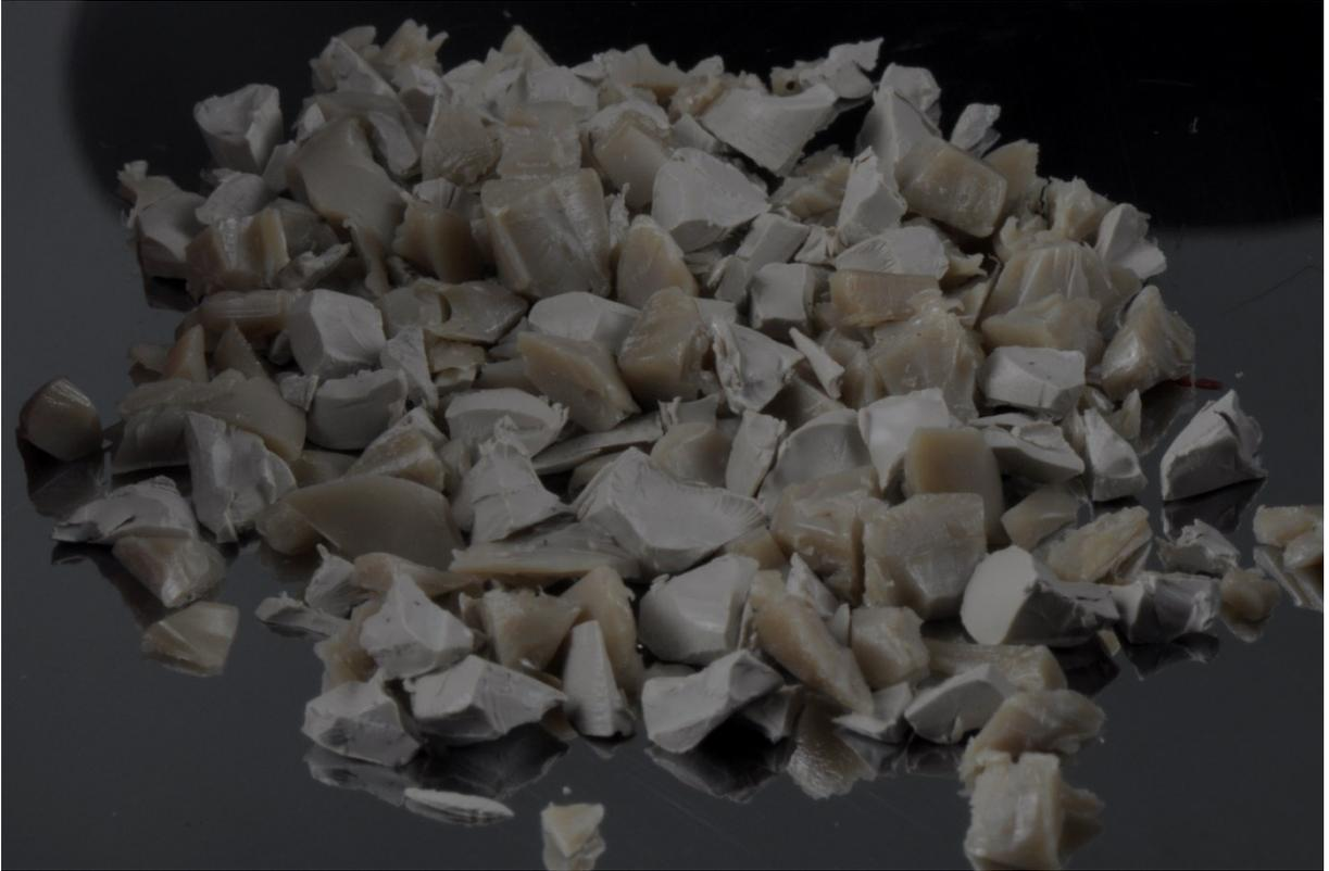
Figura 3: PEEK (VESTAKEEP I 4 R - ASTM F2026), após moagem.
