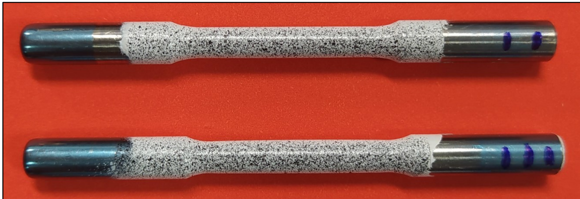
Figura 24 – Corpos de prova com padrão de speckle aplicado
