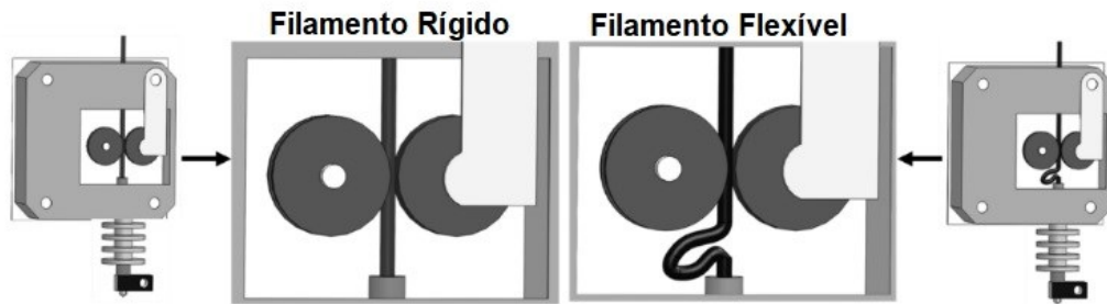
Figura 16: Diferença de comportamento de filamentos rígidos e flexíveis durante a impressão
