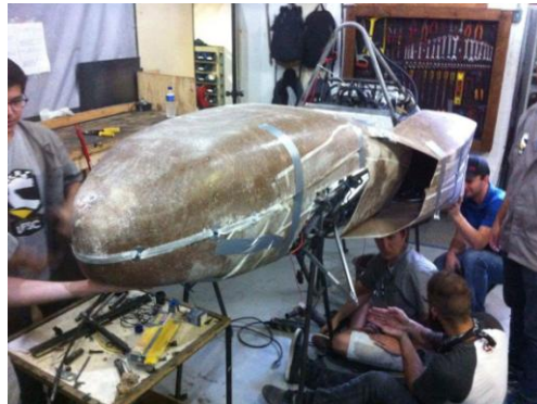
(Figura 7) – Montagem das peças de juta no chassi do veículo (elaborado pelos autores)
