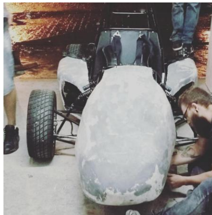
(Figura 8) – Fixação de carenagem de fibra de vidro no chassi do veículo com abraçadeira de plástico (elaborado pelos autores)
