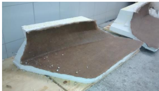
(Figura 6) –Carenagem de juta laminada em molde (elaborado pelos autores)
