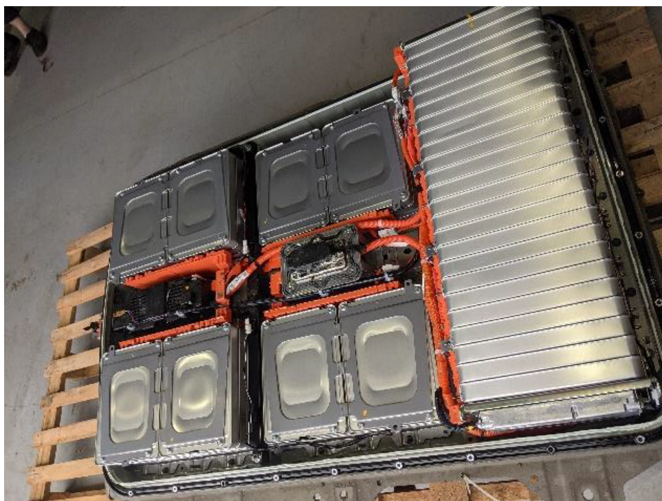
Figura 28 – Conjunto de baterias do Nissan LEAF aberto.
