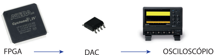
Figura 1 – Diagrama simplificado da aquisição de dados
