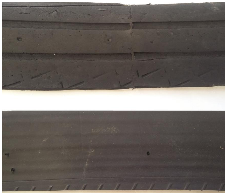
Figura 3: Banda de rodagem desmontada e aberta. Fonte: O autor.
