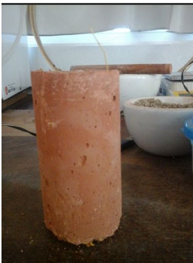
Figura 19: Corpo de prova da argamassa calfitice (cal+fibra+terra+cimento). (Fonte: autoral)
