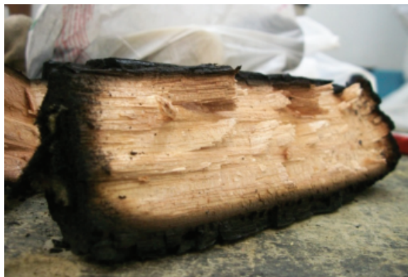
Figura 14. Seção de unidade amostral submetida a 7,5 minutos de incêndio. Fonte: Oliveira et al. (2013)
