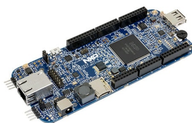
Figura 53 – Kit de desenvolvimento MPC5748G. ( NXP SEMICONDUCTOR, s.d. )
