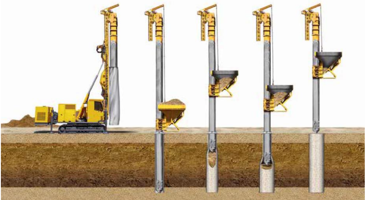
Figura 18 - Esquema executivo de colunas granulares encamisadas.
