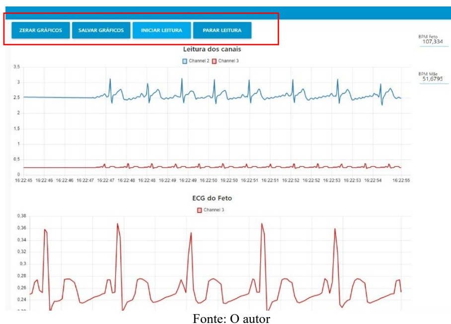
Figura 28 - Funções do sistema. Na parte superior temos os dois sinais MECG e FECG e na parte inferior uma ênfase no sinal FECG, escalas verticais em Volts e horizontais em hh:mm:ss. Circulado em vermelho temos botões com algumas opções.
