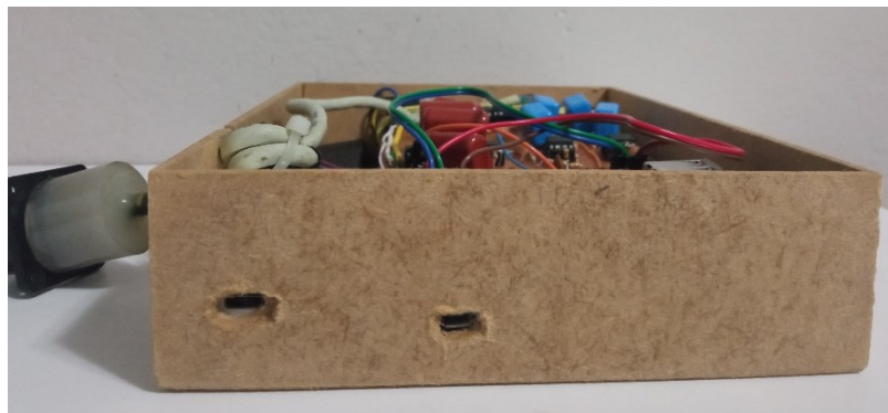
Figura 31 - Vista lateral do projeto, mostrando as entradas para alimentação, que é feita utilizando baterias.
