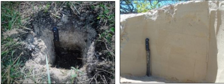
Figura 12: Abertura de poço e corte em seção colunar para coleta de sedimentos na planície costeira da área de estudo, respectivamente.
