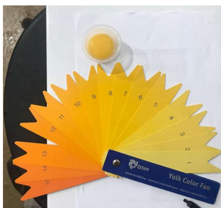
Figura 10 - Cor de gema através do leque de cores DSM Yolk Color Fan
