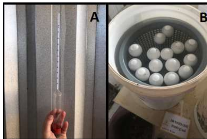
Figura 5 - Densímetro (A) e indicação da gravidade específica dos ovos (B)
