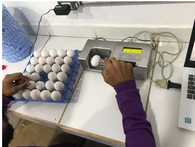
Figura 6 - Análise de resistência da casca pelo Fast-Egg-Shell-Tester (Bröring)
