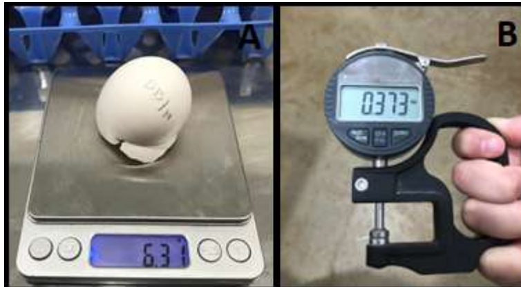
Figura 12 - Peso da casca (A) e espessura da casca (B)
